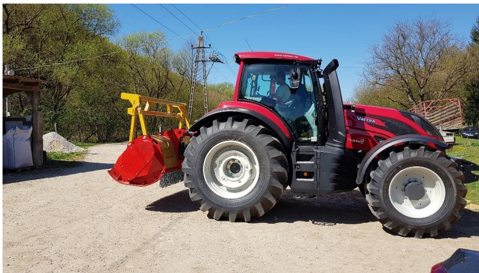
Valtra-típusú erdészeti traktor és erdészeti szárzúzó
